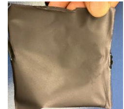
7% wt. Mxene 7% wt. SWCNT
