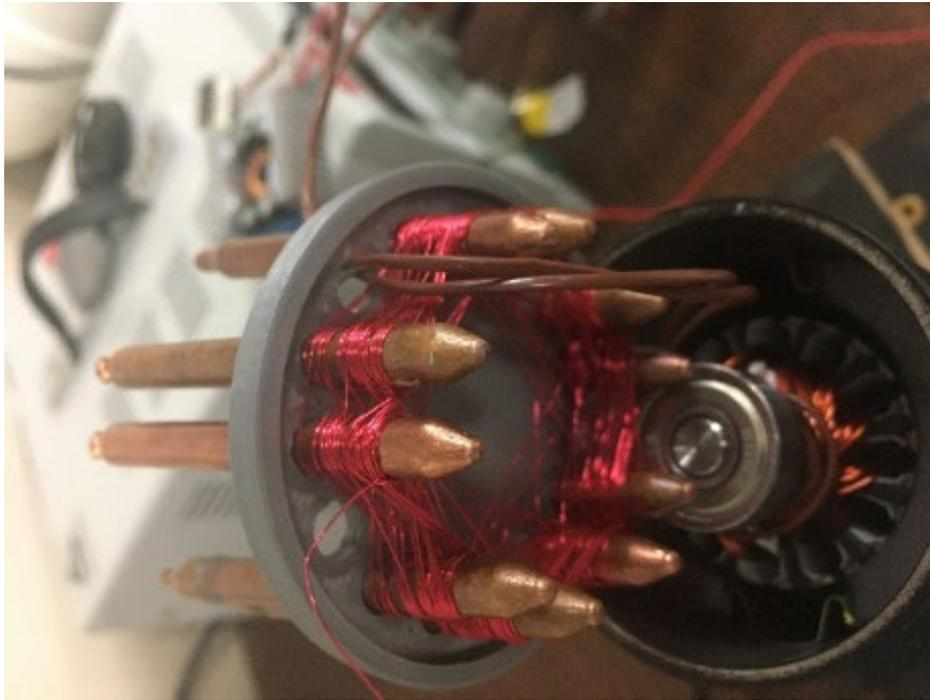
130(b). Ten heat pipes in porous fins
