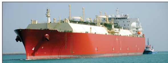
Membrane style LNG carrier
