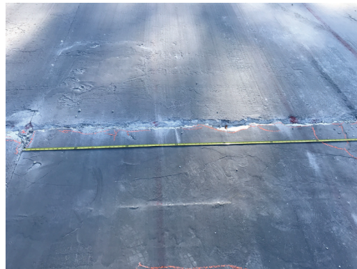
(d) Spalling in Quadrant #3 at 448 passes
