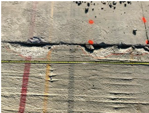
(d) FOD on the eastern edge at 112 passes
