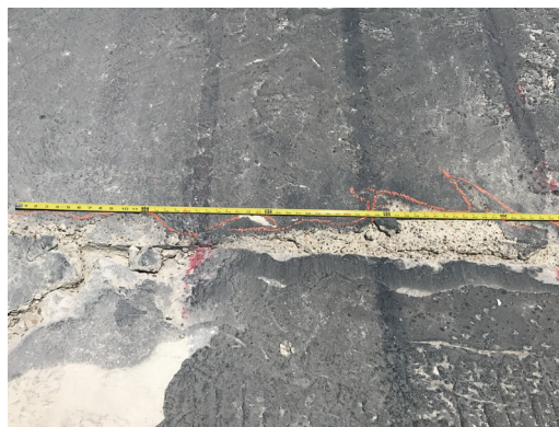
(d) Spalling on Quadrant #2 at 768 passes
