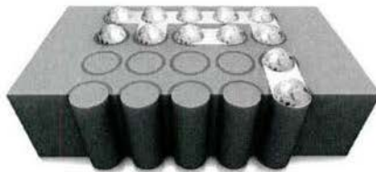
Abbildung 6.1: Das SILEX-Konzept mit gefüllten runden Durchkontaktierungen. Die Verdrahtung und das Aufbringen der Lötugeln erfolgt am Ende der Prozesskette (Bild aus Quelle [70]).
