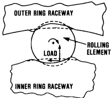
**LOADED ROLLING ELEMENT BEARING**
