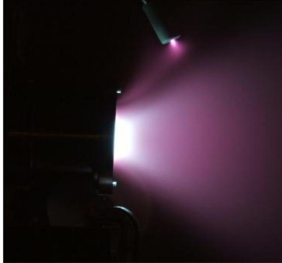
FIGURE 2.7-1 DCFT IN OPERATION
