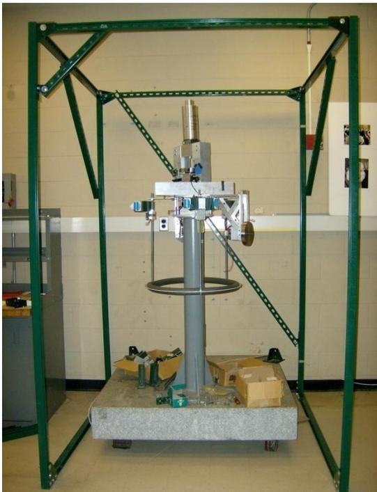
FIGURE 6.1-1: GREEN BEACON FRAME AROUND AIR BEARING
