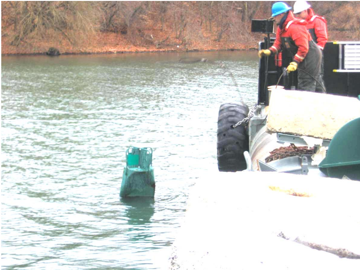
Figure B-9. Buoy recovery using lasso.
