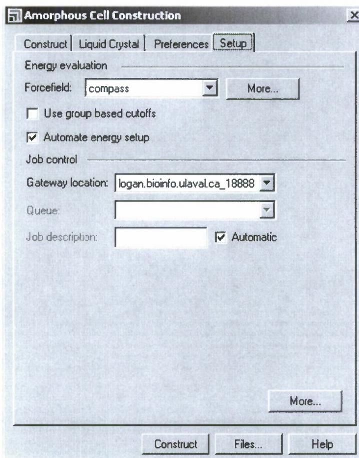
f) La fonction Construction permet d'effectuer une minimisation de la maille amorphe (amorphous cell) de « 1000 steps » immédiatement après la construction initiale de la maille, il n'est donc pas nécessaire de minimiser à nouveau la maille avec le Minimizer, puisque la dynamique moléculaire va créer un état d'équilibre d'énergie supérieure à l'état minimisé de toute façon. On cherche ici le niveau d'énergie relié à l'équilibre après une longue dynamique moléculaire (au moins 100 picosecondes).
