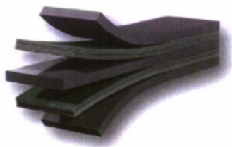
Figuur 3 Schematische weergave van een vezel-metaallaminaat.
