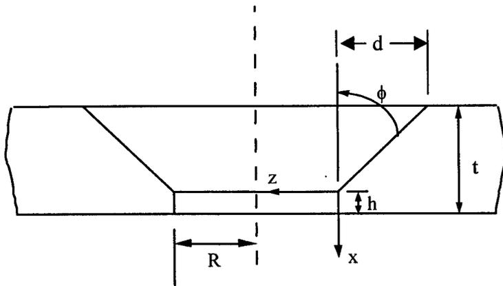
FIGURE 2. SPECIMEN GEOMETRY ( $h/t=0.2$ ,  $\phi=50^\circ$ ,  $R/t=1.954$ )
