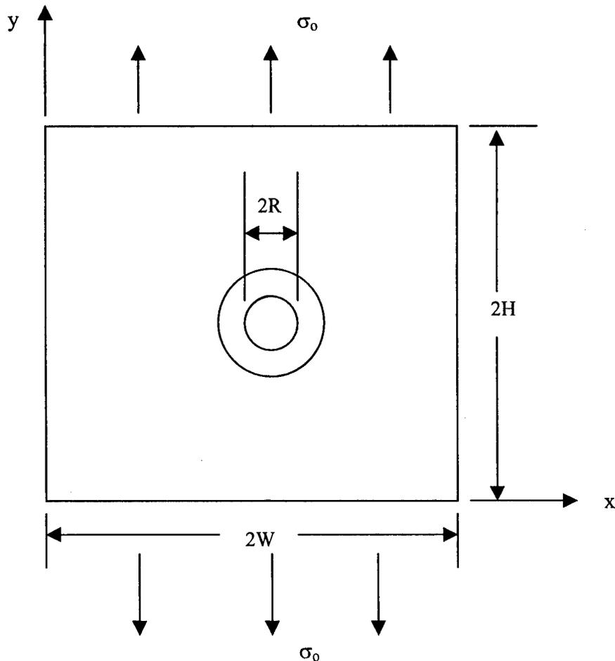
FIGURE 1. SPECIMEN GEOMETRY ( $W/H=1.0$ ,  $W/R=9.6$ ,  $\sigma_0=1$  MPa)
