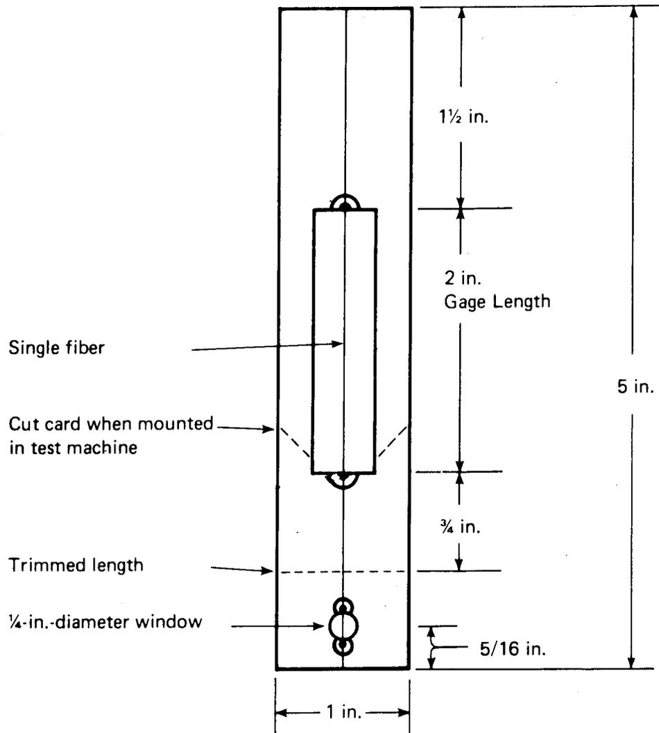
FIGURE 2-2. GRAPHITE SINGLE FILAMENT TAB TENSILE TEST SPECIMEN
