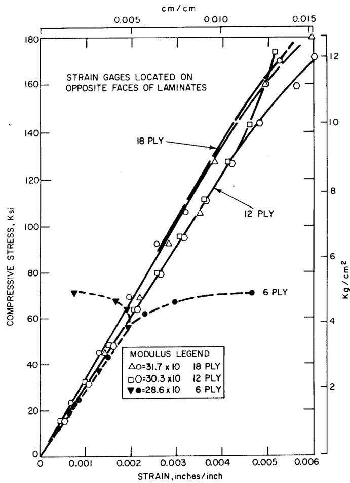
FIGURE 2-33. TYPICAL COMPRESSIVE STRESS-STRAIN RESPONSE OF BORON EPOXY<sup>(65)</sup>
