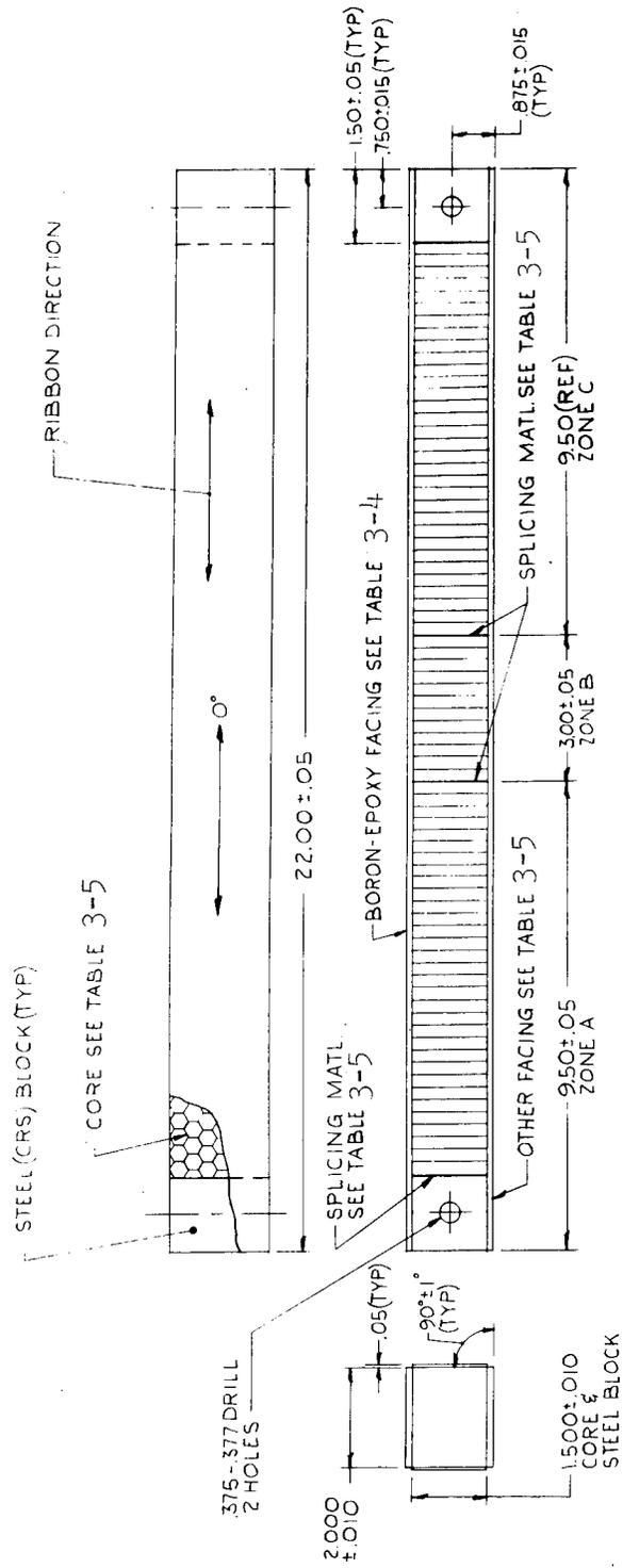
FIGURE 3-25. SPECIMEN CONFIGURATION OF HONEYCOMB SANDWICH BEAM FOR SPECTRUM LOADING (104)
