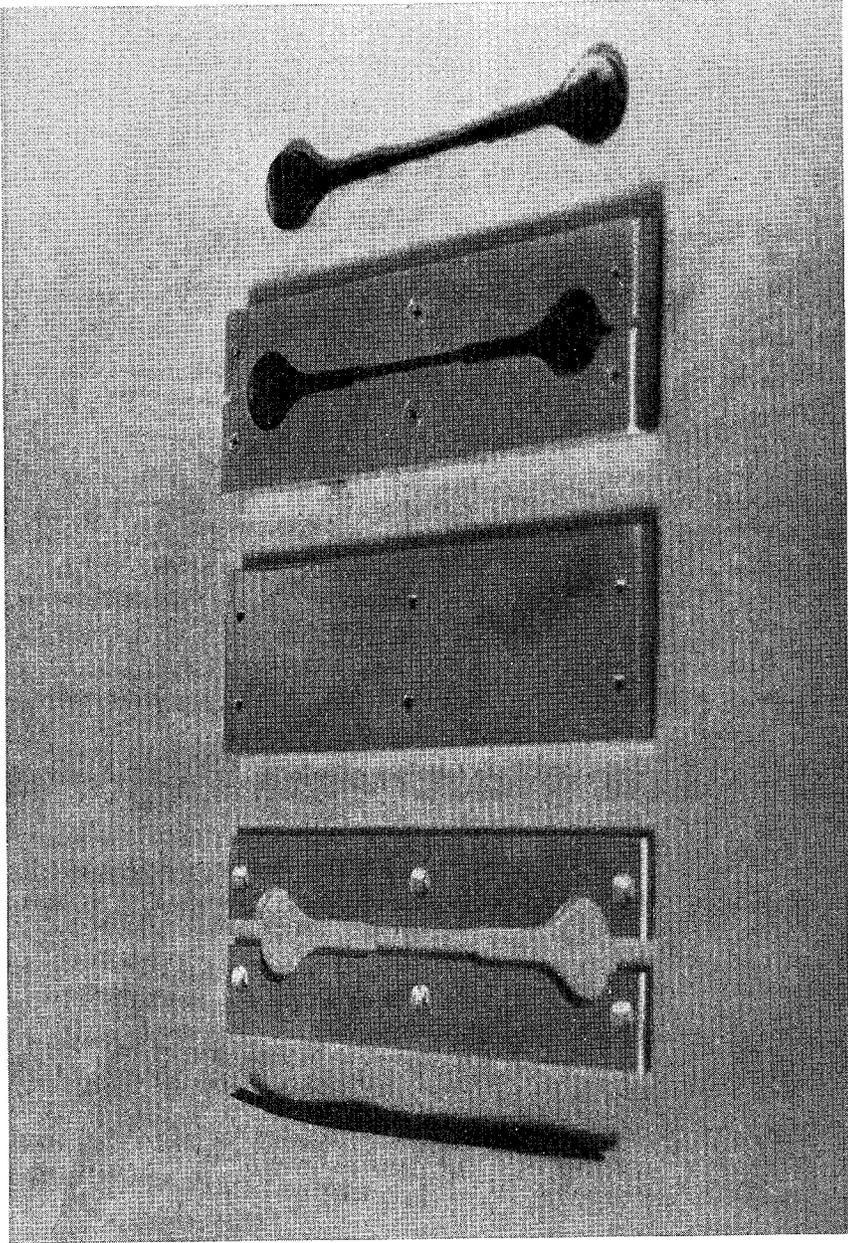
FIGURE 2-4. VIEW FROM LEFT TO RIGHT SHOWS TYPICAL TOW, DISASSEMBLED ALUMINUM MOLD, SPECIMEN AS CAST, AND SPECIMEN FOR TESTING (27)
