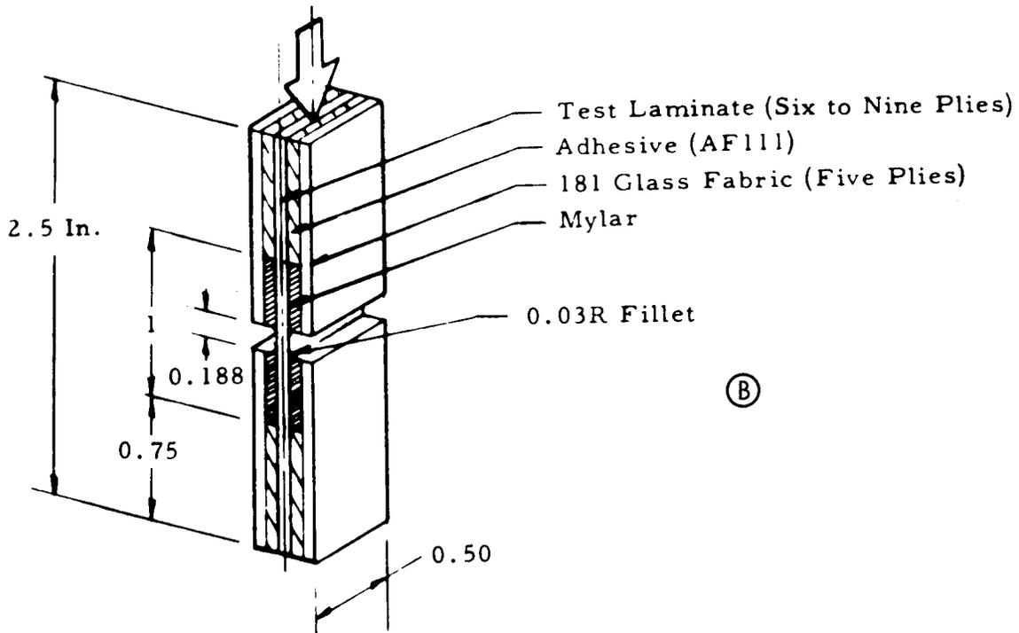
FIGURE 3-8. COMPRESSION TEST SPECIMEN TYPES<sup>(71,86)</sup>
