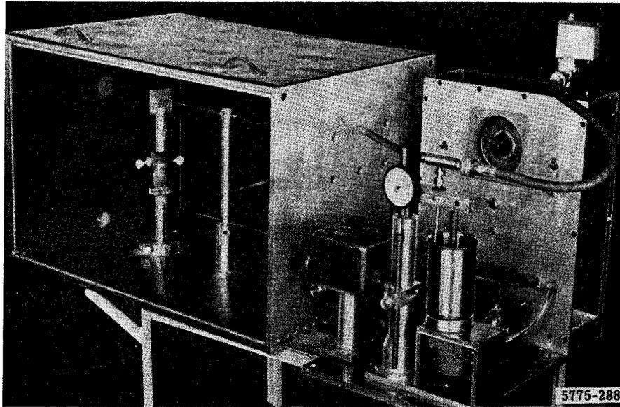
FIGURE 3-42. ABRASIVE EROSION TEST FACILITY<sup>(47)</sup>
