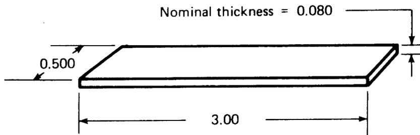
FIGURE 2-16. FLEXURE TEST SPECIMEN<sup>(46)</sup>
