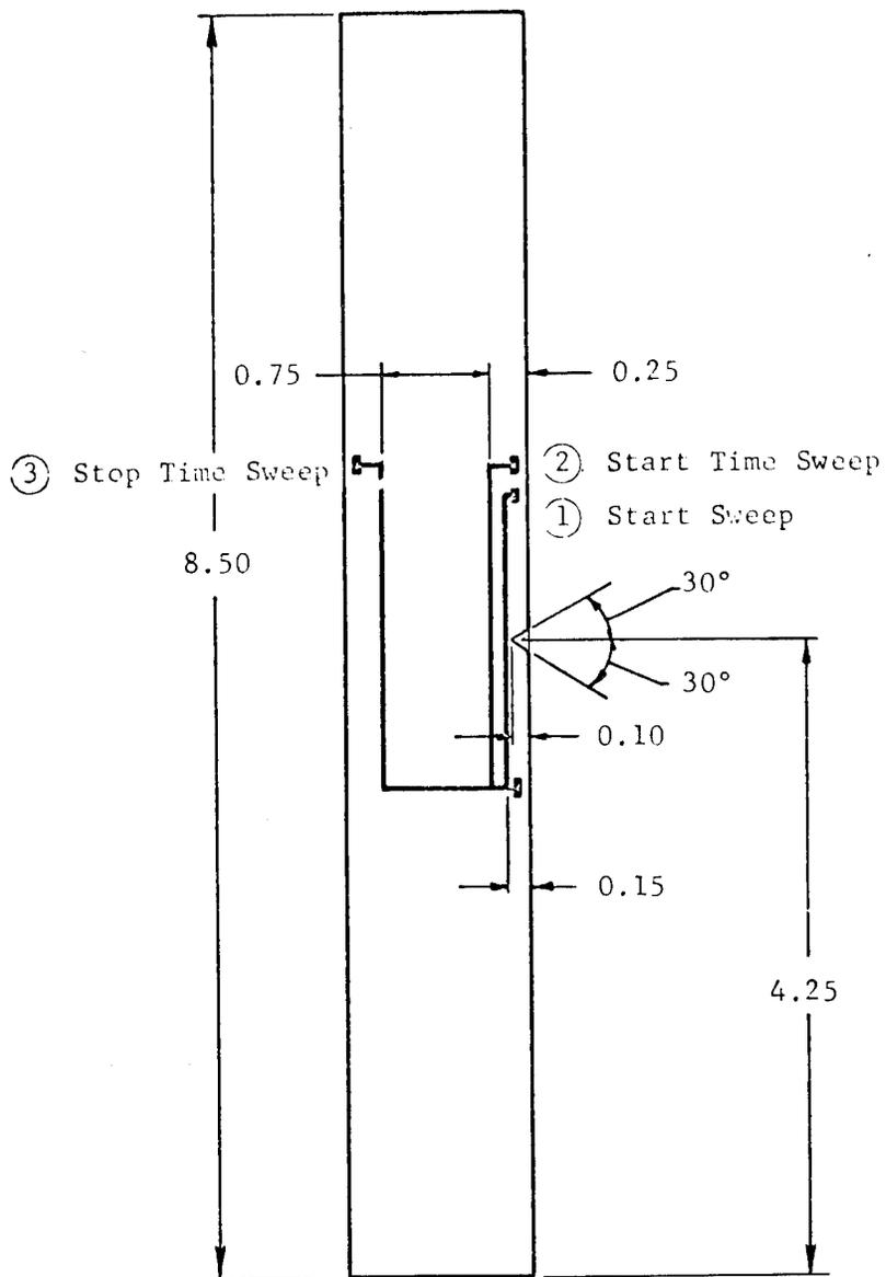
FIGURE 3-37. CRACK PROPAGATION SPECIMEN<sup>(107)</sup>
