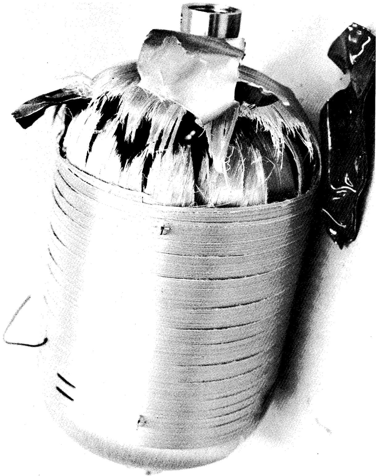
FIGURE 73— VESSEL NO. 11 AFTER BURST TEST
