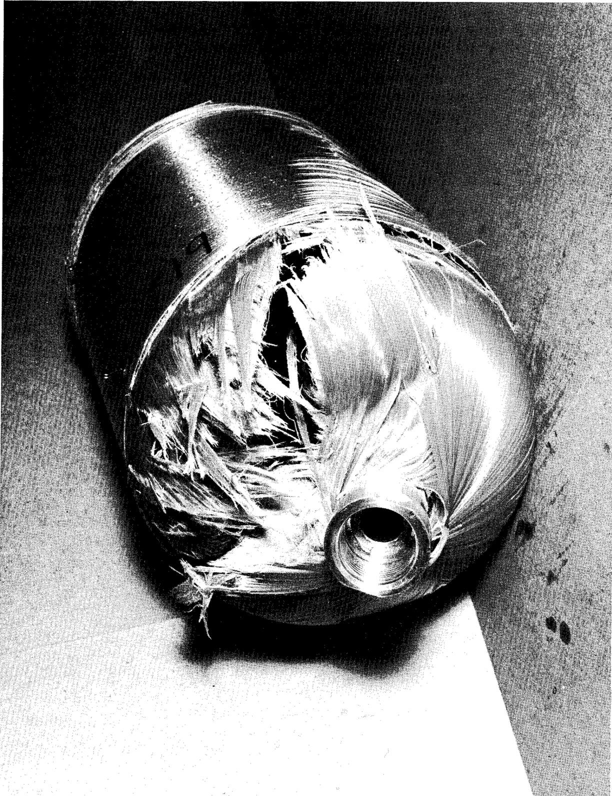
FIGURE 75--VESSEL NO. 19 AFTER BURST TEST
