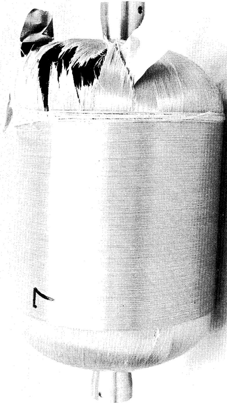
FIGURE 69—VESSEL NO. 7 AFTER BURST TEST
