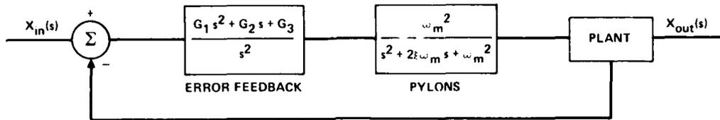
FIGURE 3. SCHEMATIC OF THE JEFF(A) AUTOMATIC CONTROL SYSTEM
