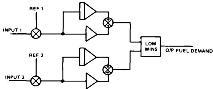
FIGURE 5 TYPICAL 2-LOOP CONTROLLER
