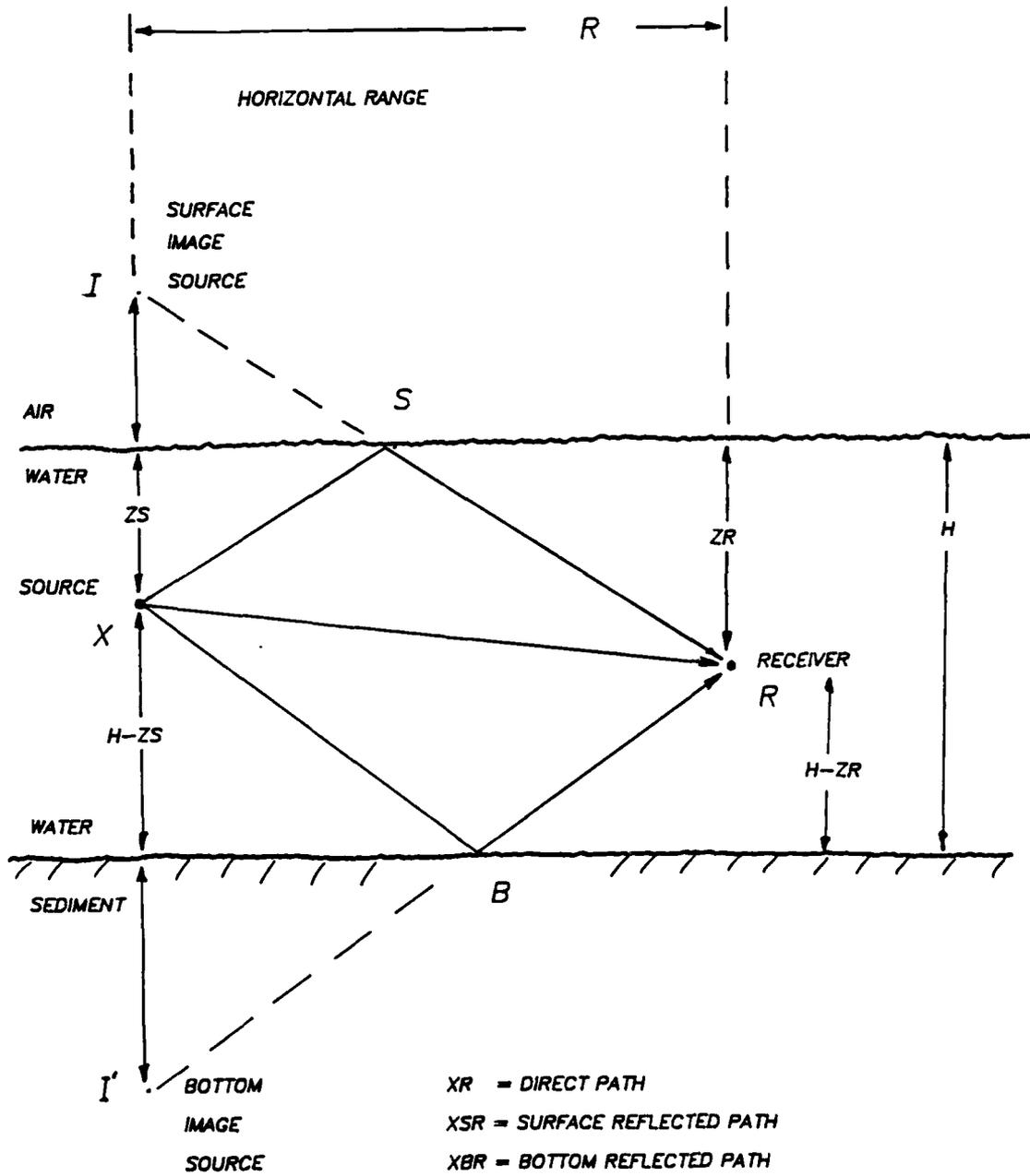
**FIG.2.4 SIMPLE MULTIPATH GEOMETRY**
