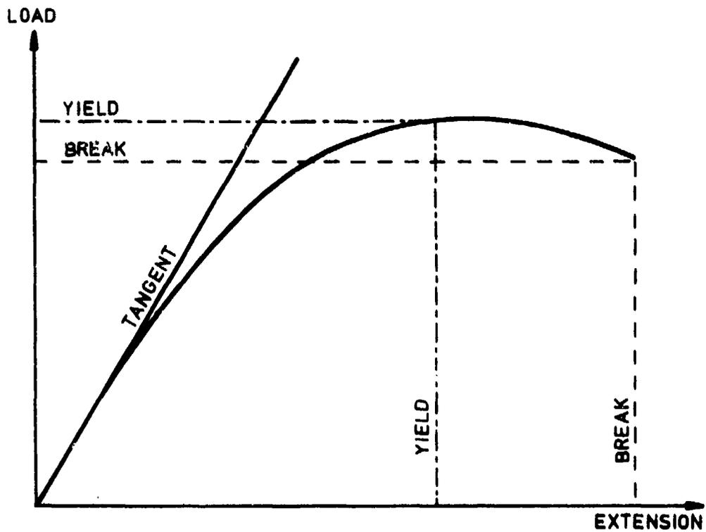
FIG. 2 TYPICAL CHART RECORD FOR A DUCTILE POLYACETAL TENSILE TEST
