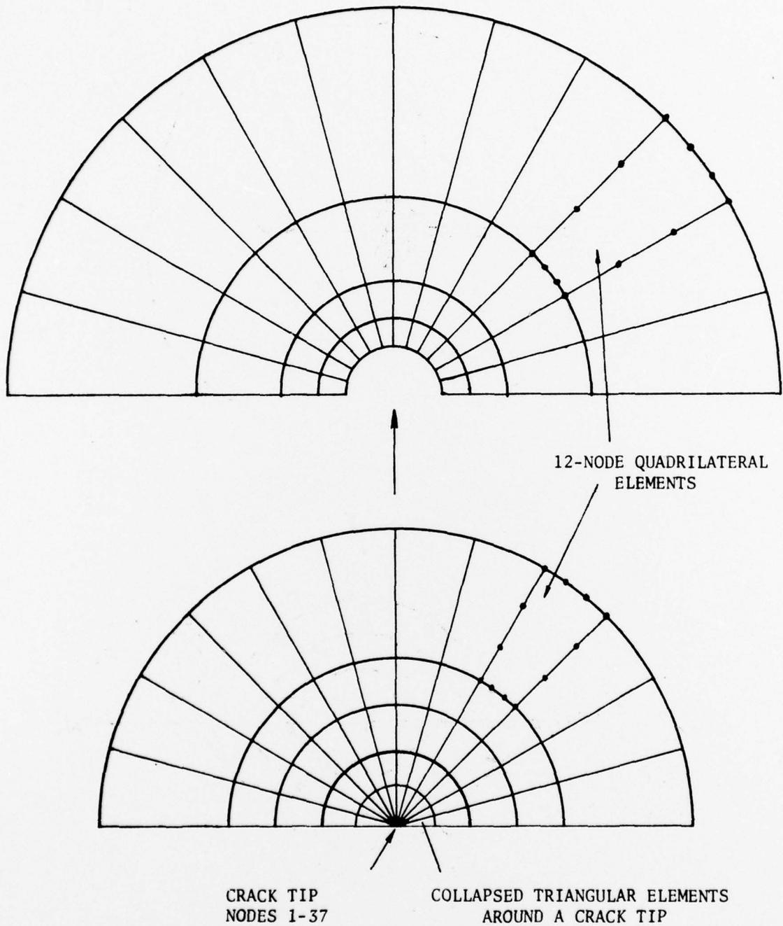
FIGURE 3. FINITE ELEMENT IDEALIZATION OF THE CRACK TIP NEAR FIELD.
