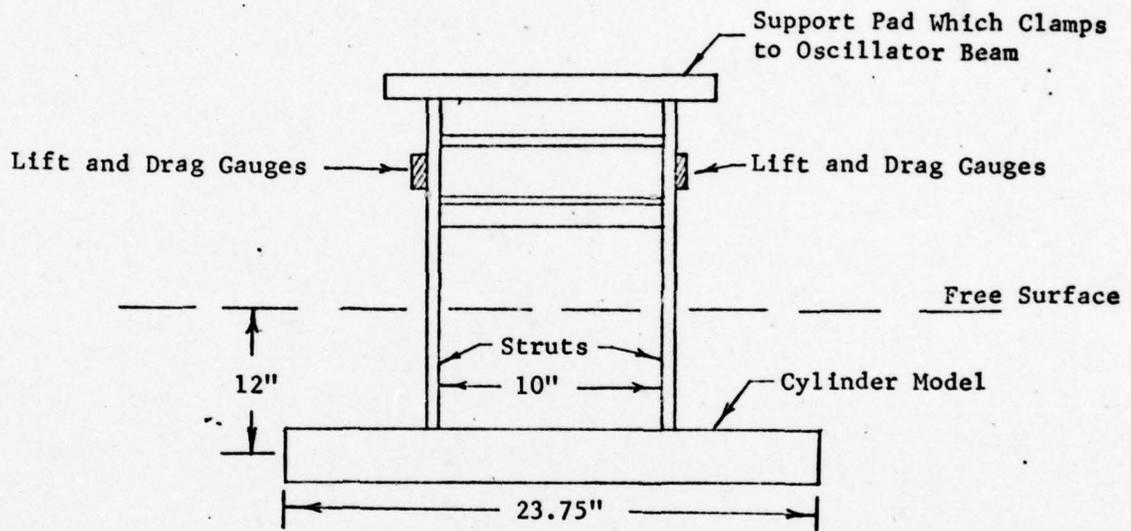
Figure 1 - Schematic of Model-Strut-Dynamometer
