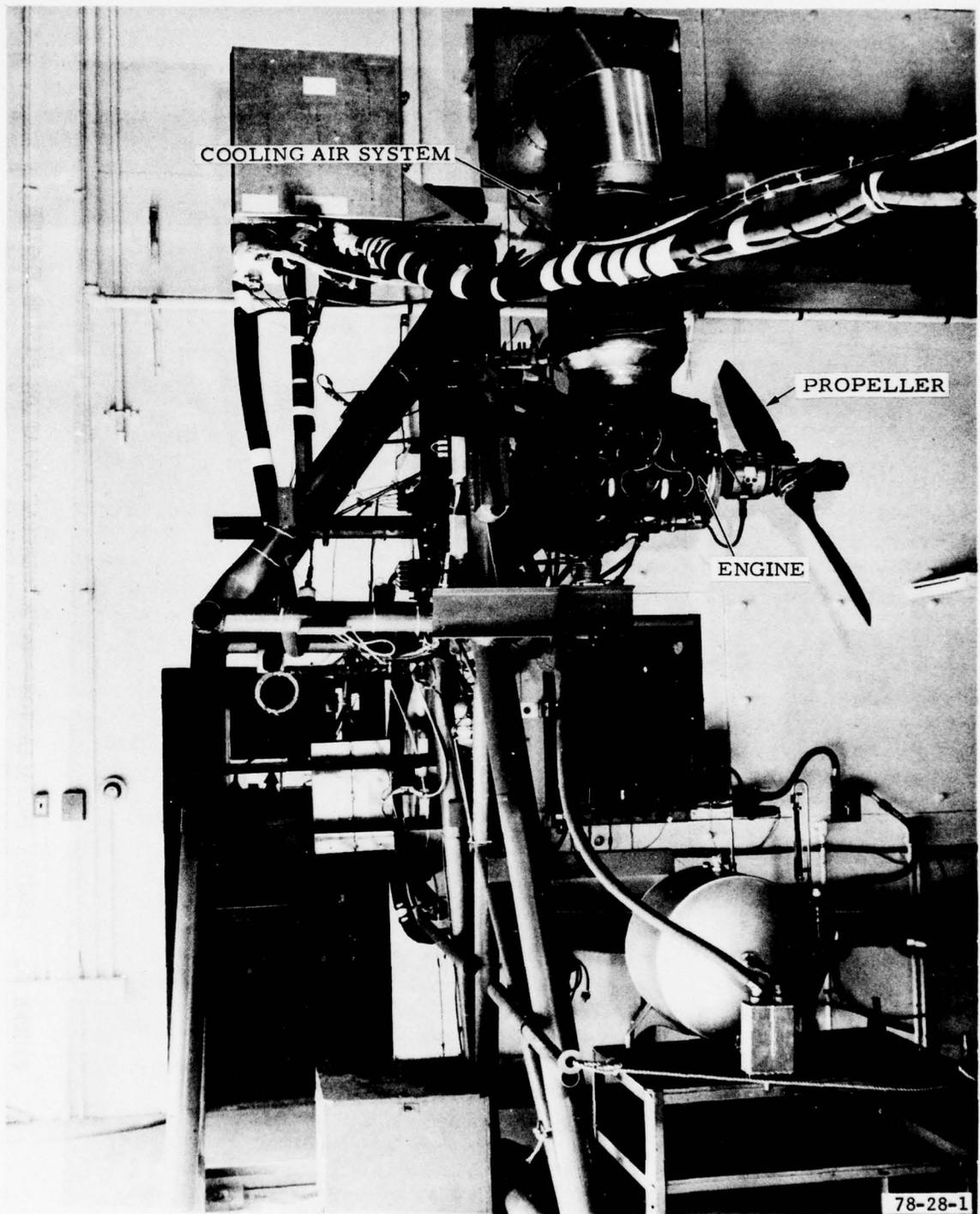
FIGURE 1. TYPICAL SEA LEVEL PROPELLER TEST STAND--PISTON ENGINE
