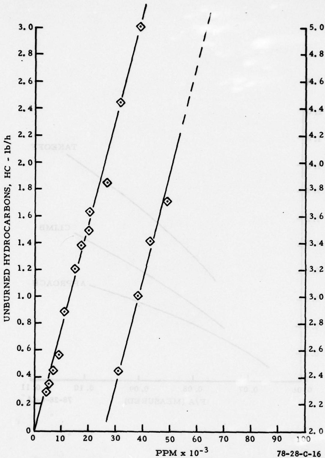
FIGURE C-18. A CALIBRATION CURVE FOR TAXI MODE UNBURNED HYDROCARBONS--
