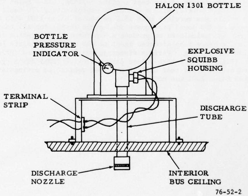
FIGURE 2. HALON 1301 BOTTLE INSTALLATION
