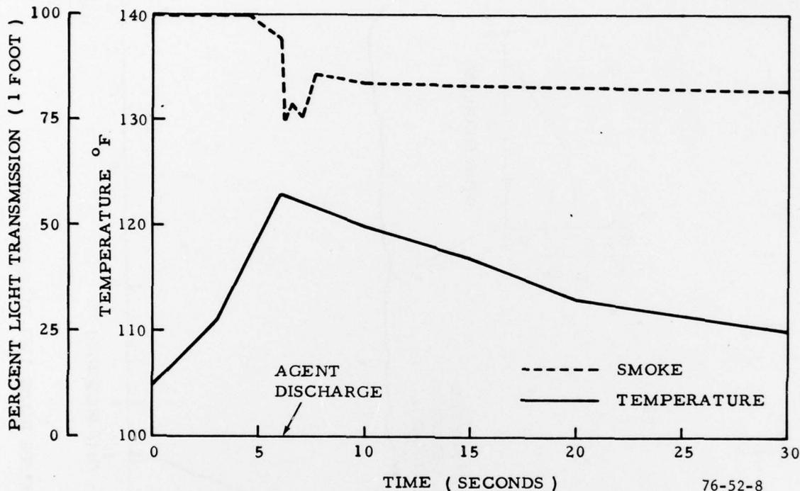
FIGURE 8. RAPID EXTINGUISHMENT OF A FUEL-SOAKED BUS SEAT
