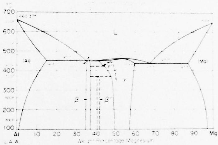
Figure 1 - ALUMINUM-MAGNESIUM PHASE DIAGRAM.
