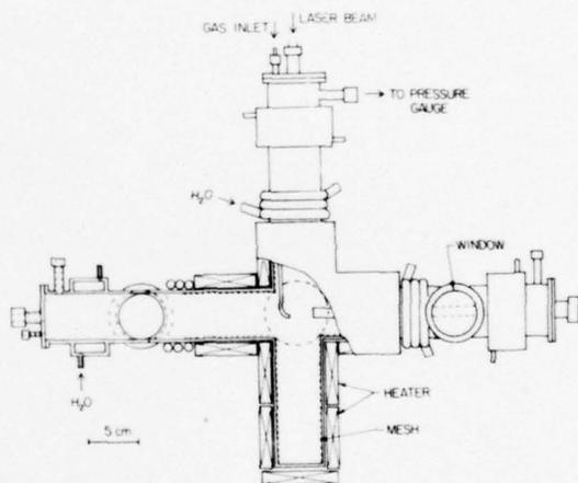
Fig. 1. Heat pipe oven.
