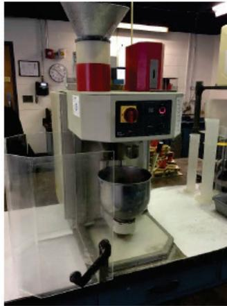
FIGURE 1: FULLY AUTOMATED PASTE/MORTAR MIXER
