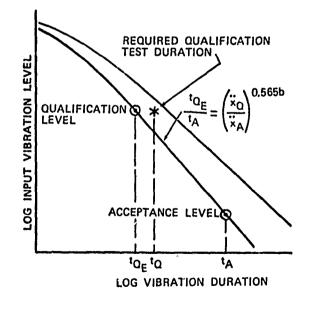
FIGURE 6. ILLUSTRATION OF QUALIFICATION TEST DERIVATION
