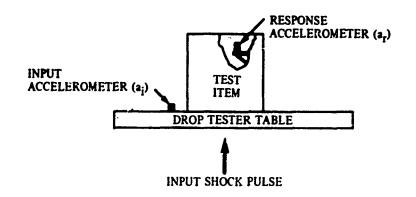
Figure 9a. Accelerometer Placement.
