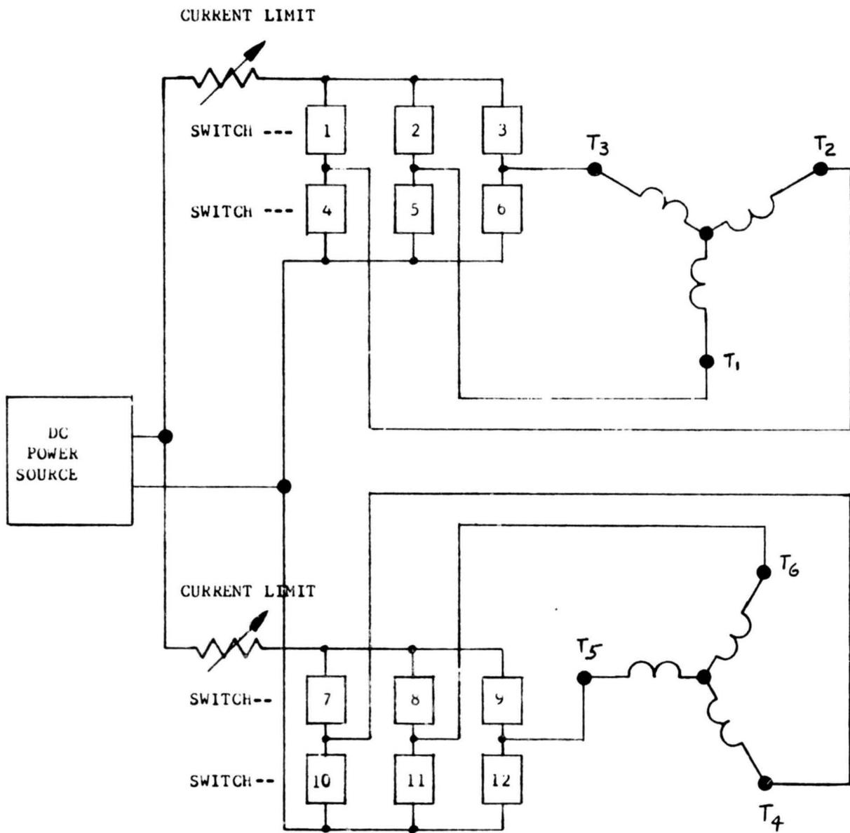
INTERWIRING OF STATIC COMMUTATOR ROTORS
