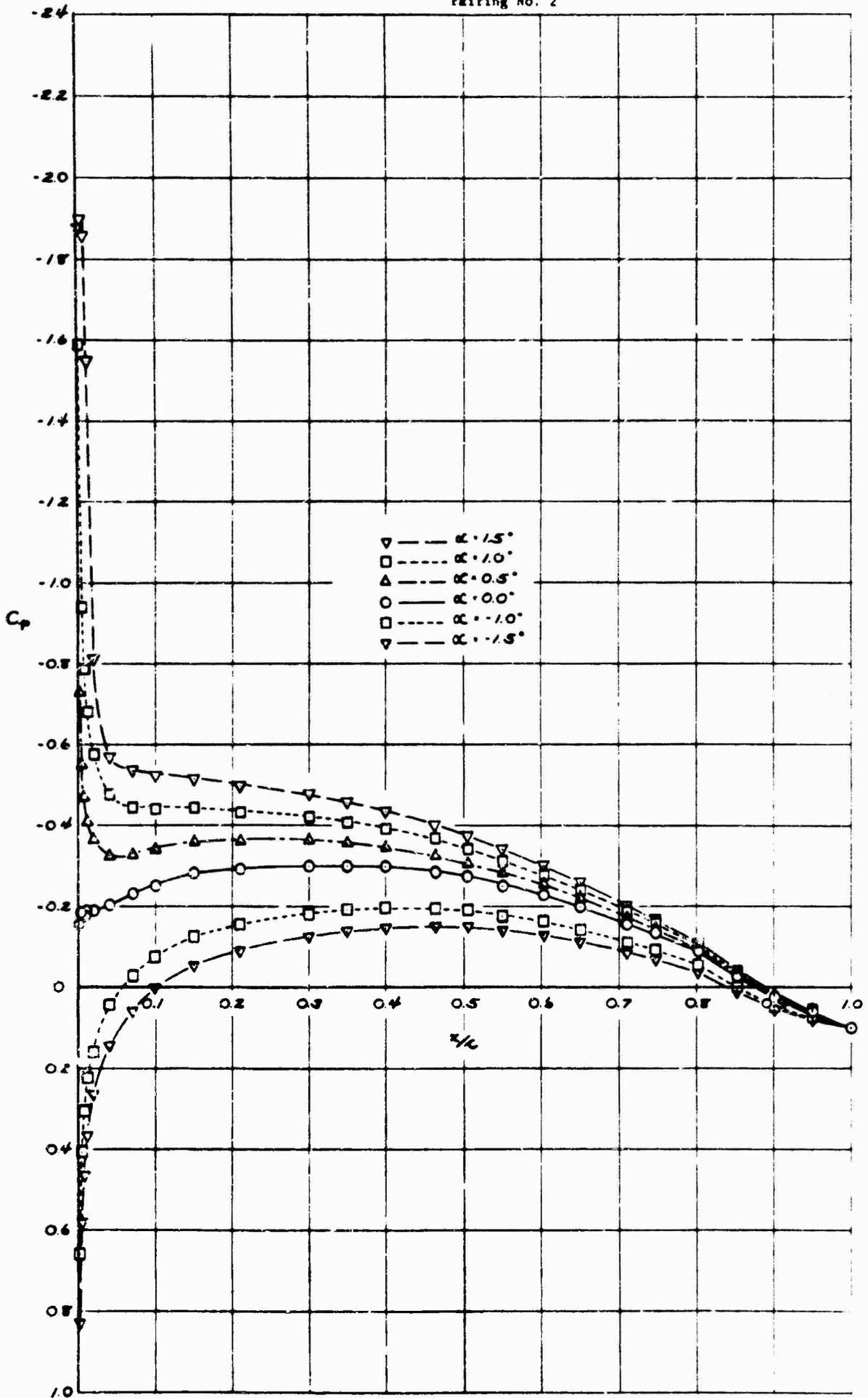
FIGURE 34 PRESSURE DISTRIBUTIONS AT VARYING ANGLES OF ATTACK
