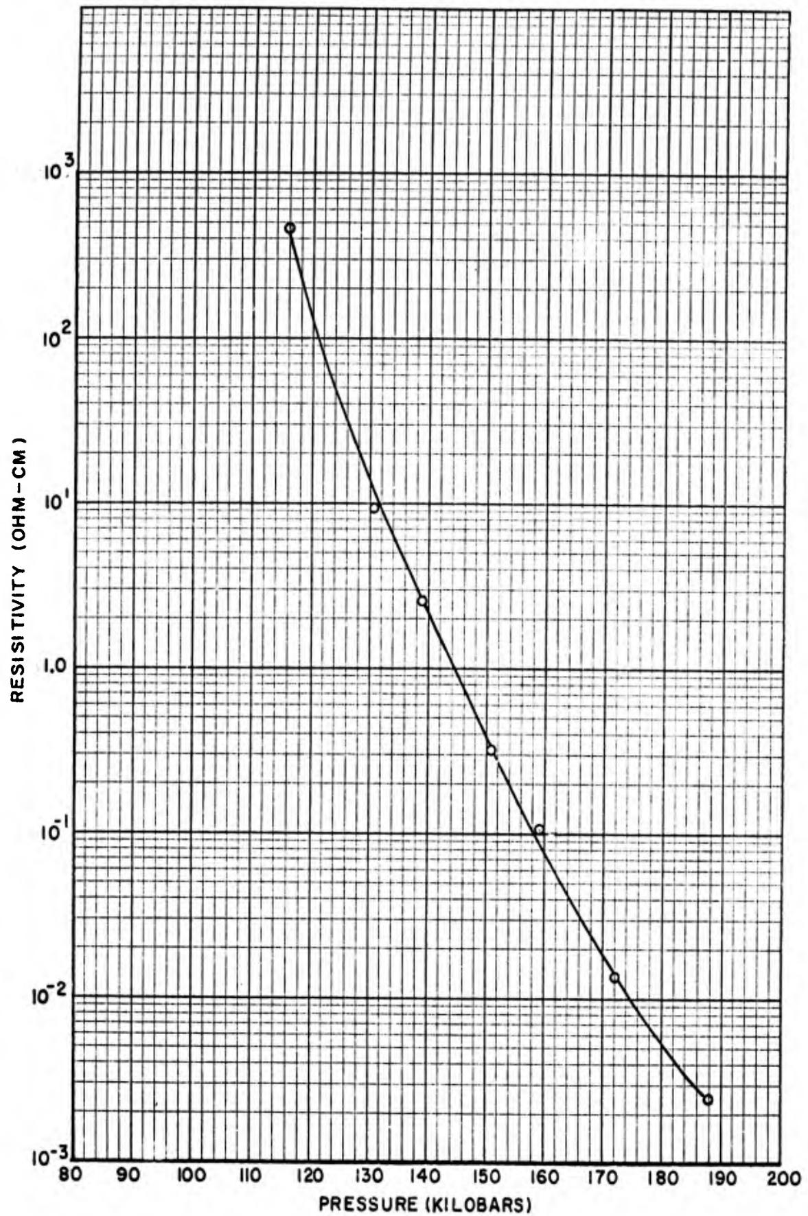
FIG. 5-SULPHUR CALIBRATION CURVE
