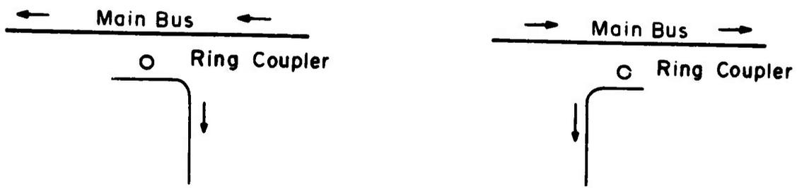
Fig. 42a UNIDIRECTIONAL COUPLING ARRANGEMENT
