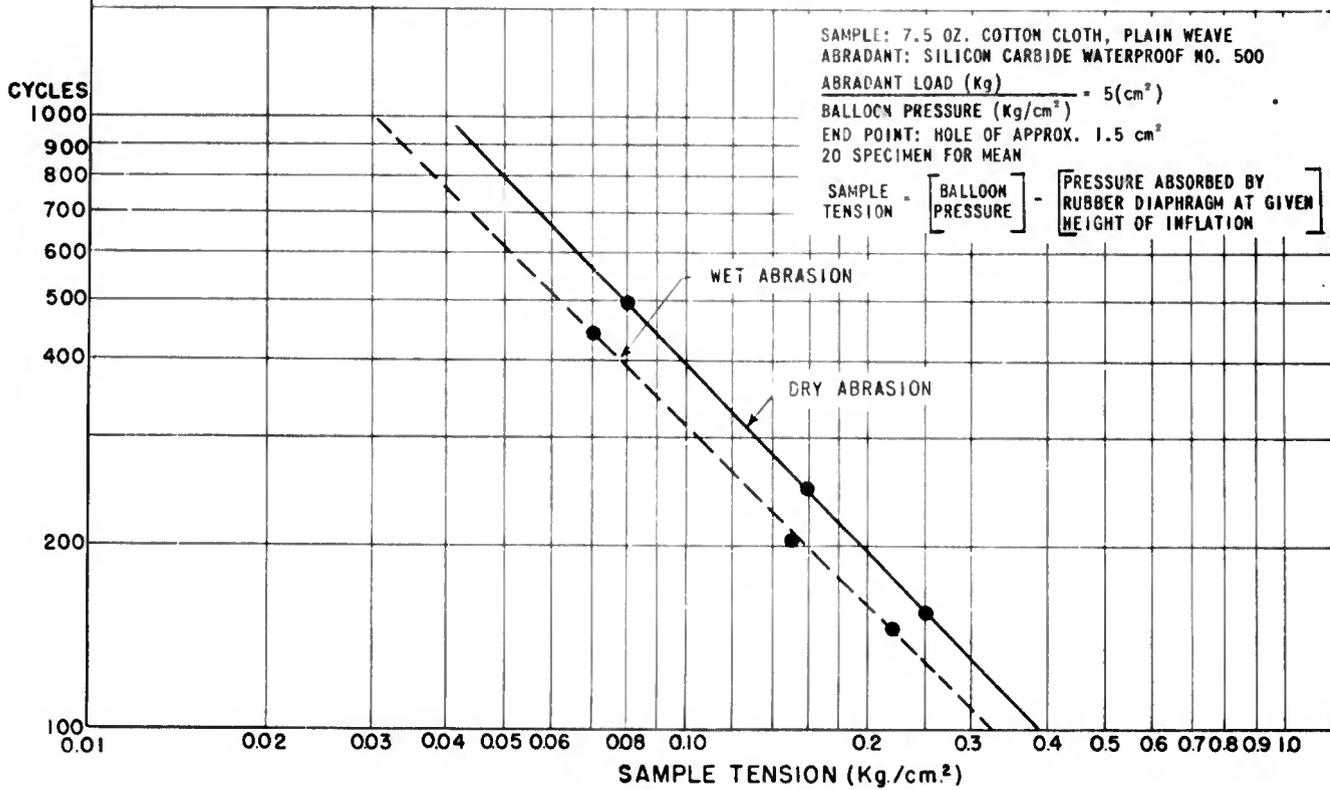
FIG. 13 - RELATION BETWEEN SAMPLE TENSION & RESISTANCE TO FLAT ABRASION
