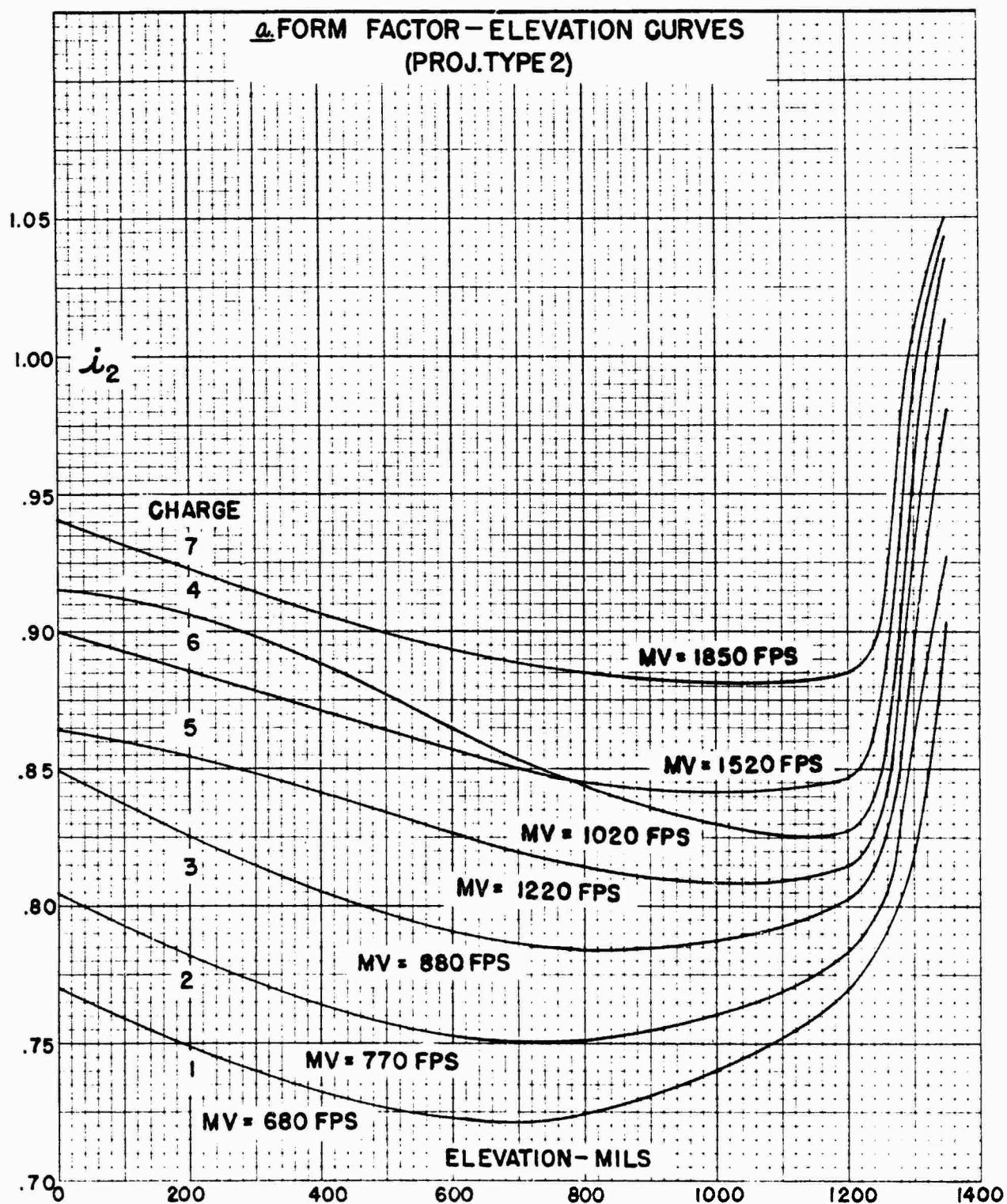
6. BALLISTIC COEFFICIENT-ELEVATION CURVES
