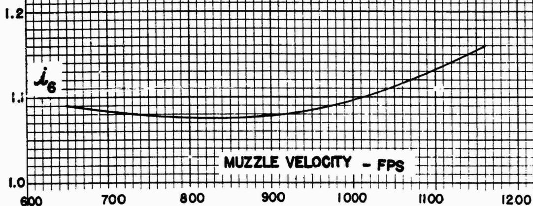
b. BALLISTIC COEFFICIENT - MUZZLE VELOCITY CURVE
