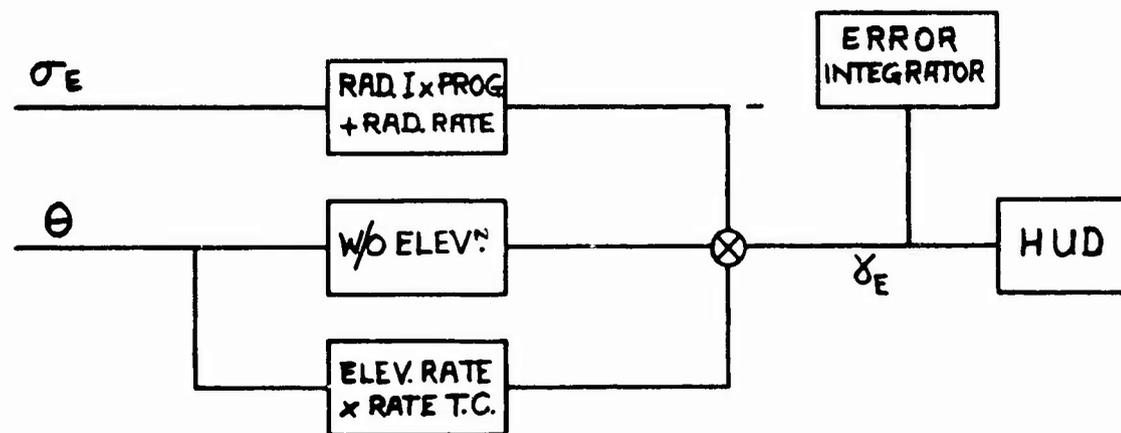
FIGURE 27B ELEVATION COMMAND COMPUTATION
