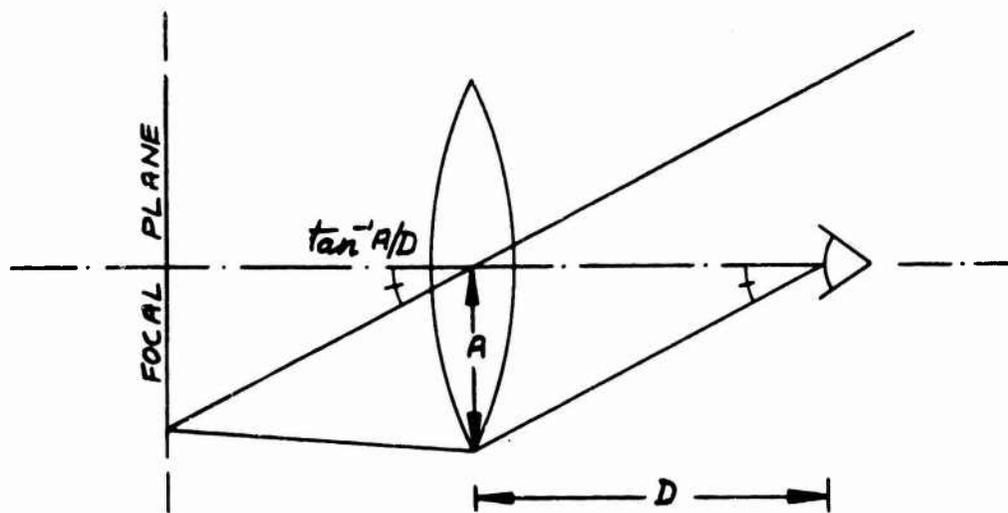
FIGURE 12 INSTANTANEOUS FIELD OF COLLIMATOR
