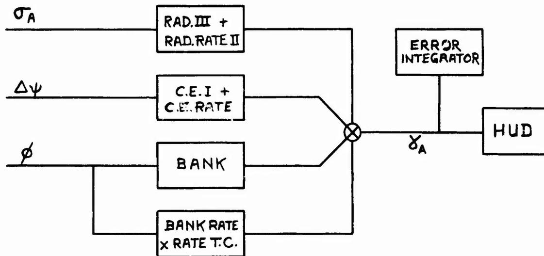
FIGURE 27A AZIMUTH COMMAND COMPUTATION
