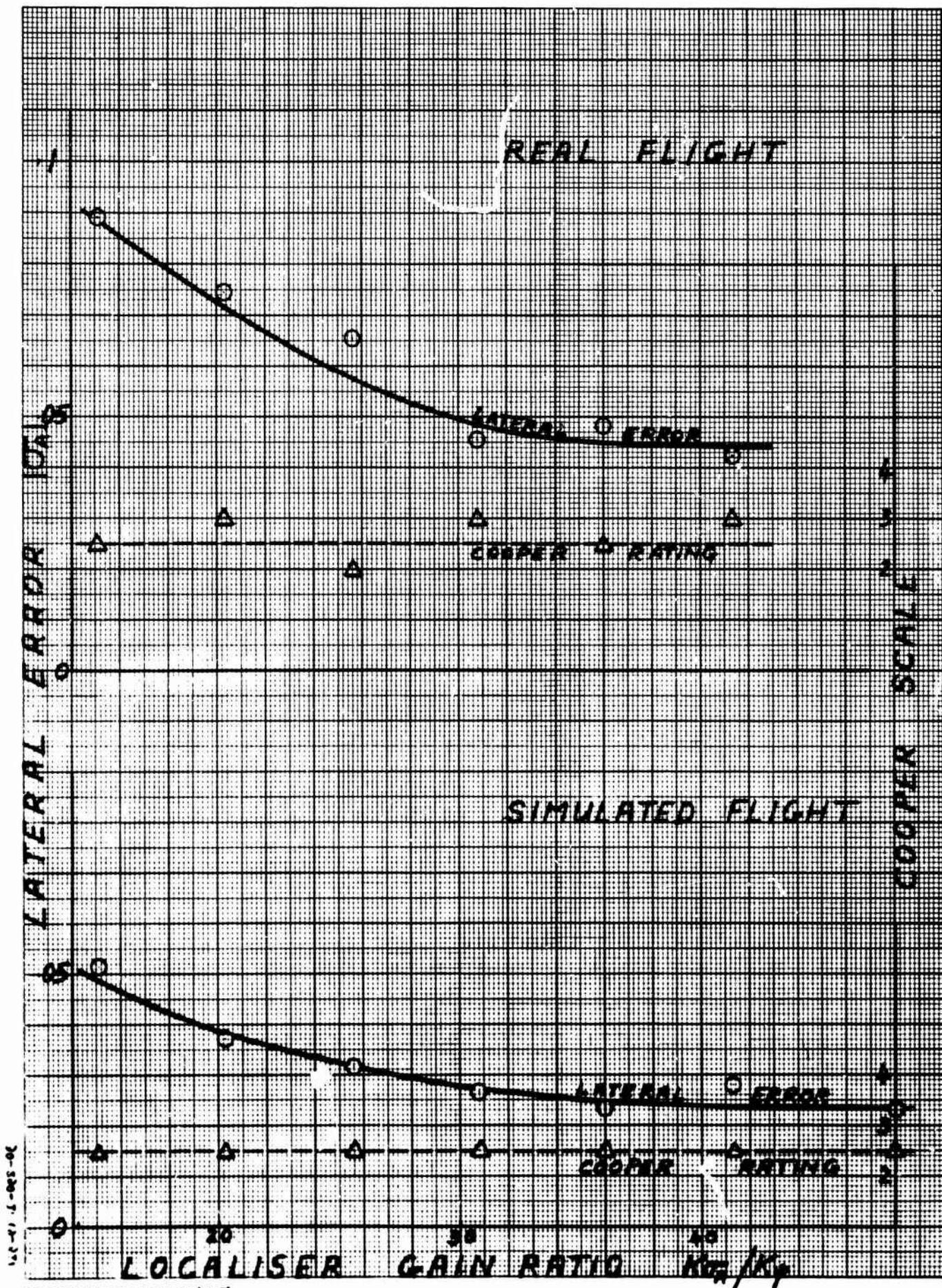
FIGURE 35 INFLUENCE OF LOCALIZER GAIN RATIO ON TRACKING AND COOPER RATING
