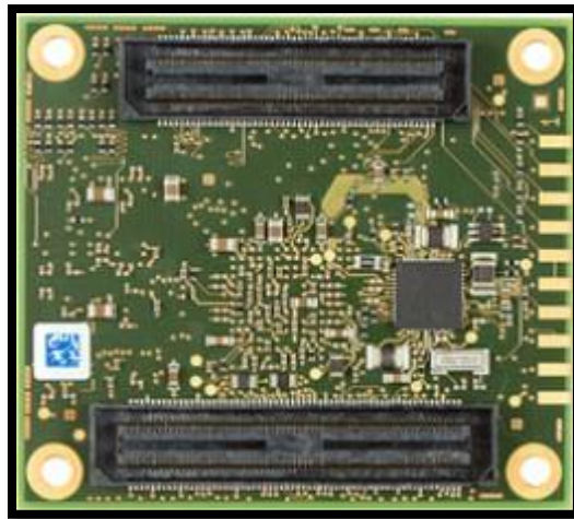
Figure 7 - PHYTEC AM335x SoM Bottom Side
