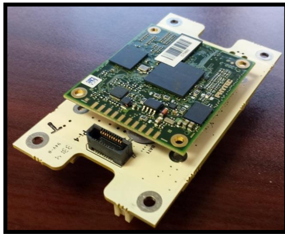
Figure 6 - Controller, showing Linux SoM
