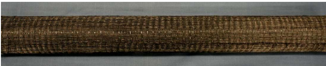
Fig. 9-9. Longitudinal layer wrap.
