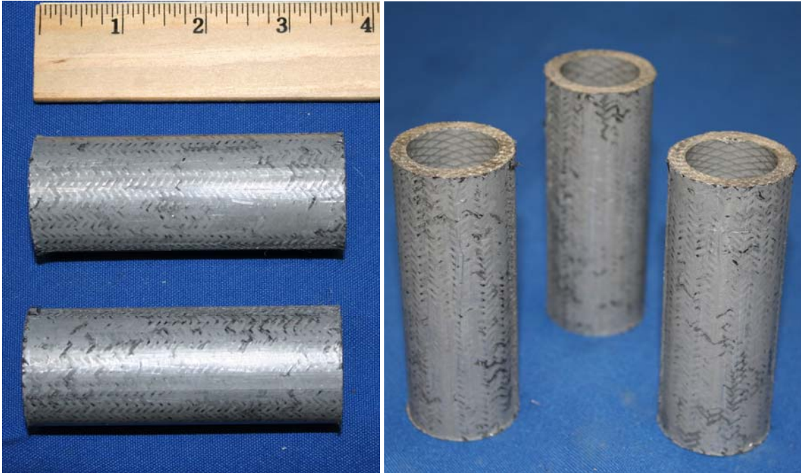
Fig. 10-1. ARA blast test specimens ( M/C = 3 ).
