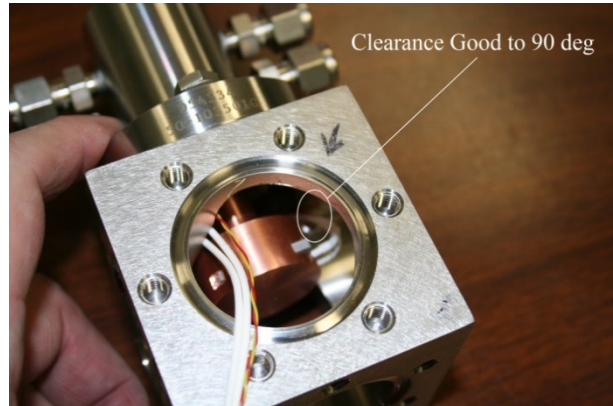
(d) Cu Block and Heat Element
