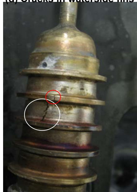
(d) Cracks in waterside fins
