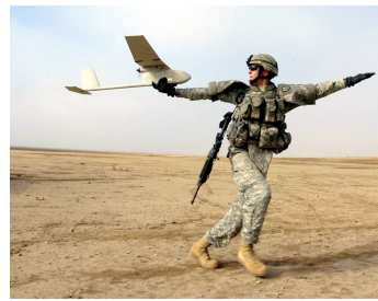
(d) RQ-11 Raven 130cm wingspan 1.9kg typical
