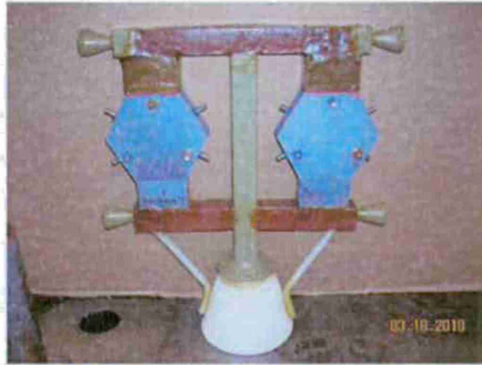
FOPAT Patterns with Gating, Sprues and Pour Cup
