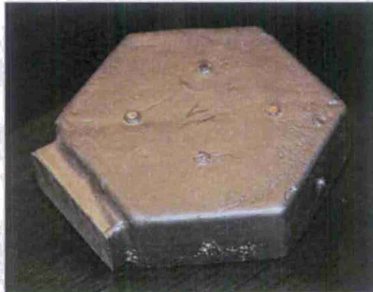
Spokane pour 1 in 8630 – no visible metal cracks
