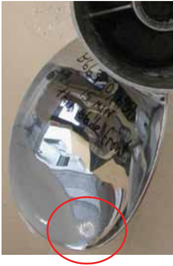
316L Prop (15 min) Fin perforation
