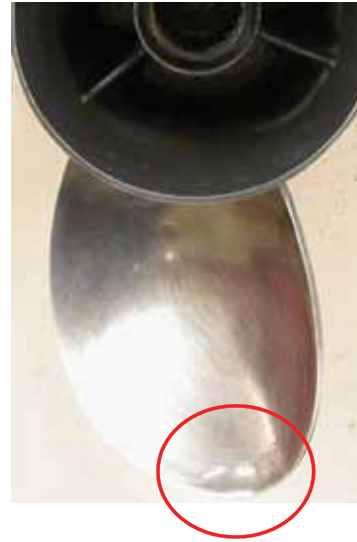
LTIH-316L Prop (60 min) Fin perforation
