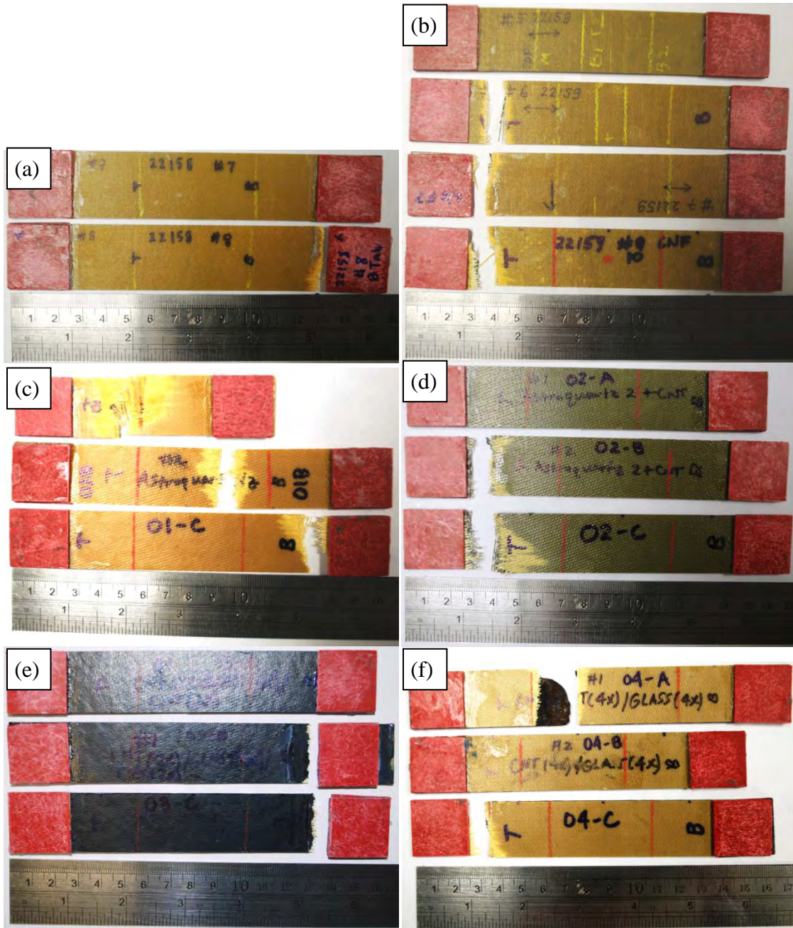
Figure 48. Test specimens: (a) 8G/CNT, (b) 8G/CNF, (c) 8G, (d) (G/CNT) 4 , (e) 2CNT/4G/2CNT, (f) 4G/4CNT
