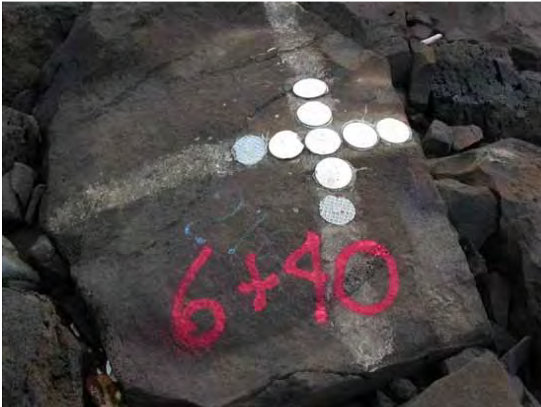
Figure D7. Sta 6+40, survey marker.
