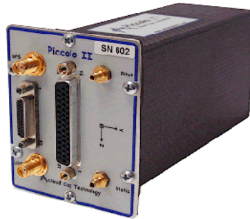
Figure 2. Piccolo II Airborne Avionics Package (Vaglianti et al., 2005:9)
