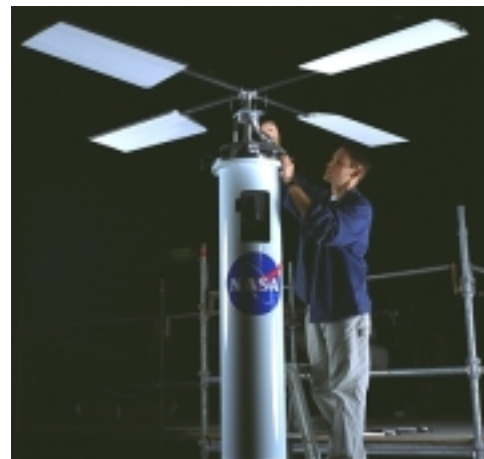
Fig. 10 – Mars Rotor Hover Test Stand
