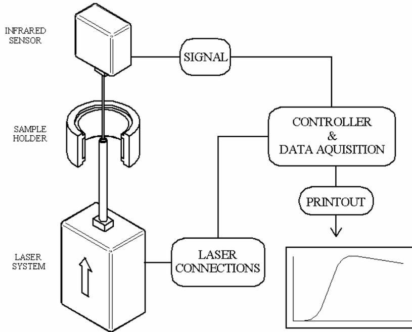
Figure 3.6.2. Laser flash instrument apparatus.
