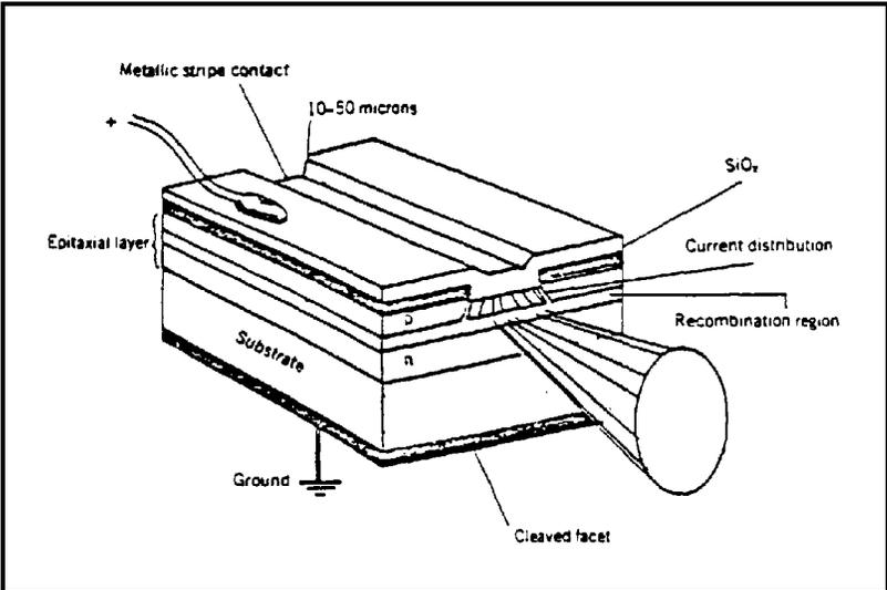
Figure 23. Diode Laser
