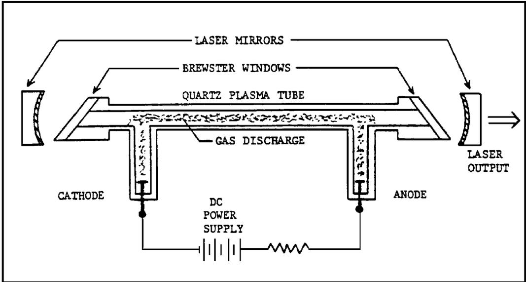
Figure 22. Helium-Neon Laser
