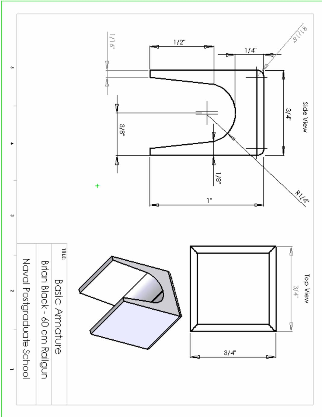
Figure 25. Basic U-Shape Armature
