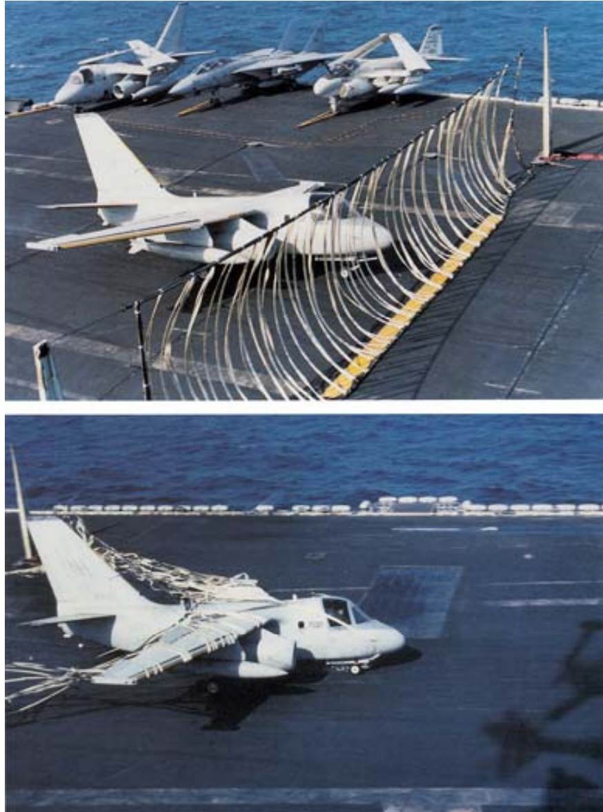
FIGURE 20. Actual Barricade Landing.
