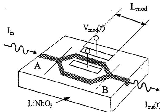
Fig. I. 2. LiNbO<sub>3</sub> Mach-Zehnder modulator
