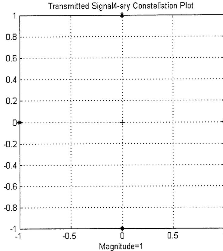
Figure 37. Constellation Plot Of DQPSK Modulation.
