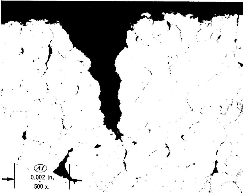
a. Stress-Rupture Tested
