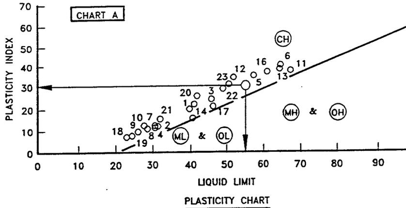
PLASTICITY OF REMOLDED CLAYS FROM FLUVIAL DEPOSITS
